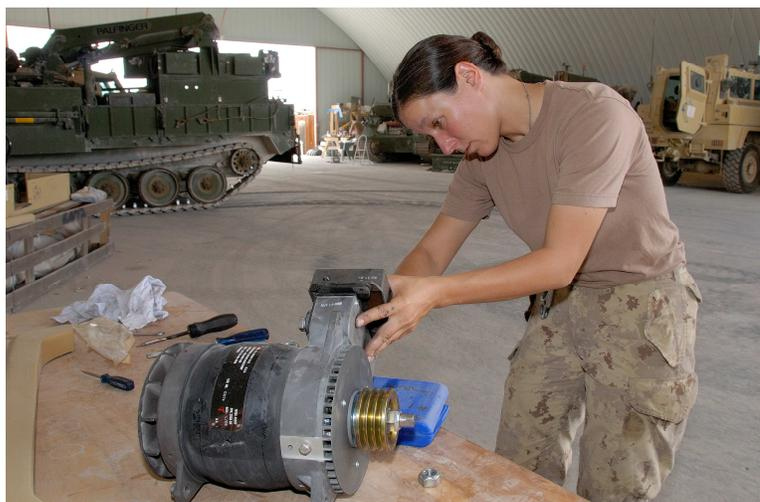
Le Caporal Heather Skaling, technicien de véhicules de l'Élément de soutien national, répare l'alternateur d'un véhicule blindé léger (VBL III) à l'aéroport de Kandahar.
