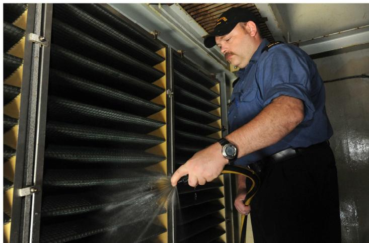
Le Maître de 2<sup>e</sup> classe, Tony Brooks, mécanicien de marine (MEC MAR), à bord du navire canadien de Sa Majesté (NCSM) Winnipeg, nettoie les filtres d'admission d'air de la turbine du moteur à essence. La turbine du moteur à essence est le même moteur qu'utilise un DC 10 dont la puissance de propulsion est de 22 000 chevaux-vapeur.
